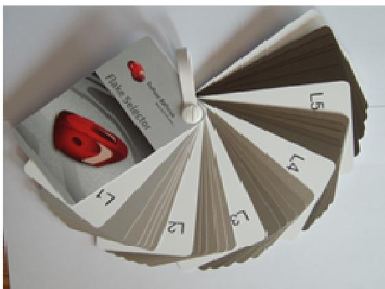
Flake Selector представляет собой веер из 25 карточек: на каждый из 5 уровней светлоты (L 1 – 5) приходится по 5 эффектных уровней (E1 – E5). С помощью данного веера олорист определяет уровень светлоты и размер зерна в лакокрасочном покрытии автомобиля, сравнивая выкраски из веера с покрытием на автомобиле.
